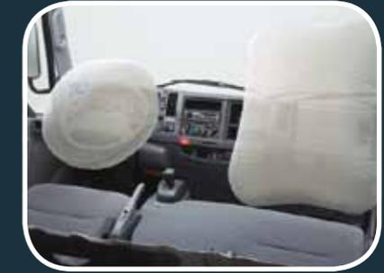
Doble airbag SRS de serie en toda la gama. Los dos airbag frontales se activan inmediatamente para proteger el rostro y la cabeza durante un accidente. Además, el columna de dirección absorbe el impacto cambiando de forma para reducir los traumas de la parte superior del cuerpo.
